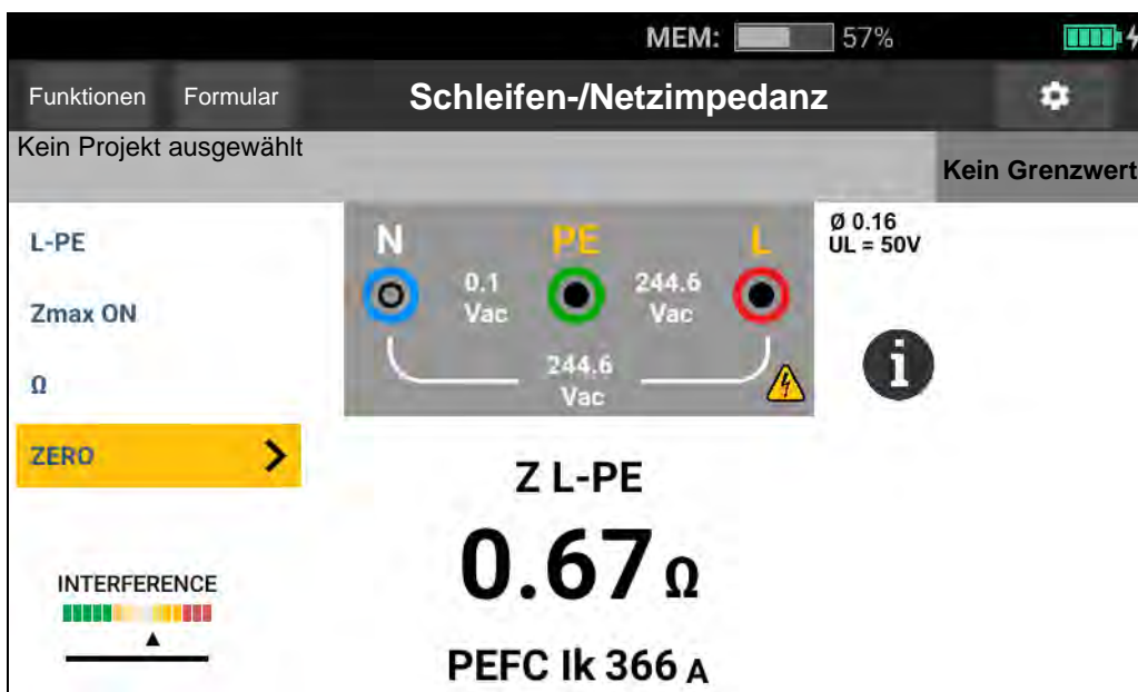
Abbildung 12. Bildschirm Messung von Schleifen-/Netzimpedanz im Auslösemodus
